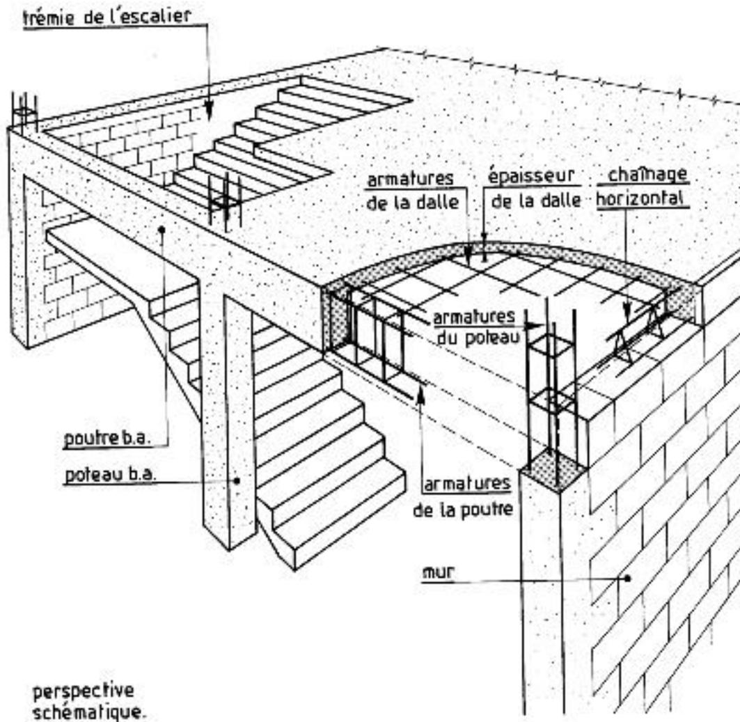
Ces planchers sont constitués d'une dalle pleine en béton (de 15 à 20 cm d'épaisseur) armée soit avec un treillis soudé, soit avec des aciers ligaturés.
