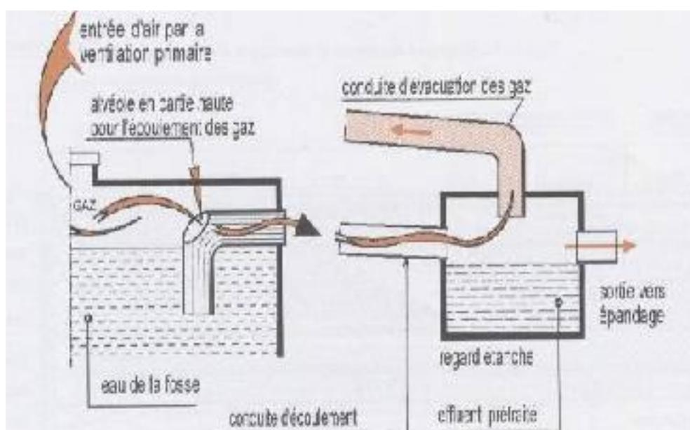
Schéma de principe d'évacuation des gaz dans la fosse
