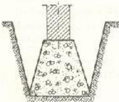
D. Fondations en béton armé
