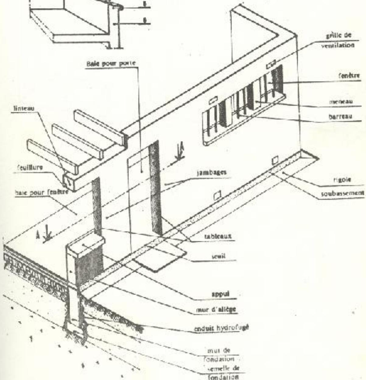
L'appui couvre l'allège sous la fenêtre et rejette les eaux de ruissellement provenant de celle-ci. un rejingot (saillie sous le dormant de la fenêtre) arrête les remontées d'eau poussées par le vent. l'appui peut être arasé, saillant sans oreille, ou saillant avec oreille.
