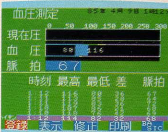
↑血圧測定中の画面表示。下に過去5回の測定値と、平均値が表示されている。
